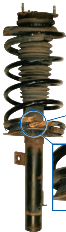
Ressort à boudin d'origine défaillant
